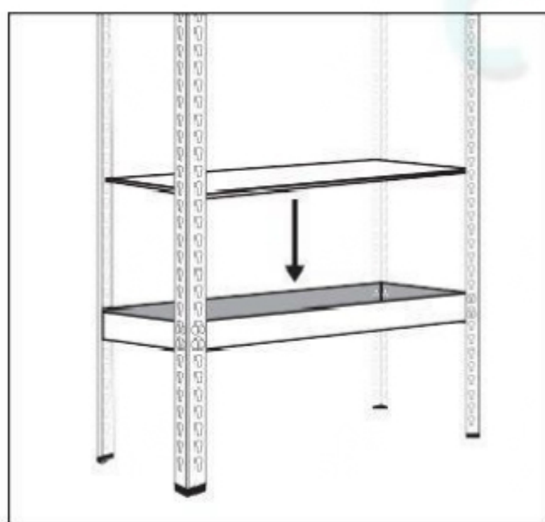
Рис. 4а. Укладка фанерного настила
