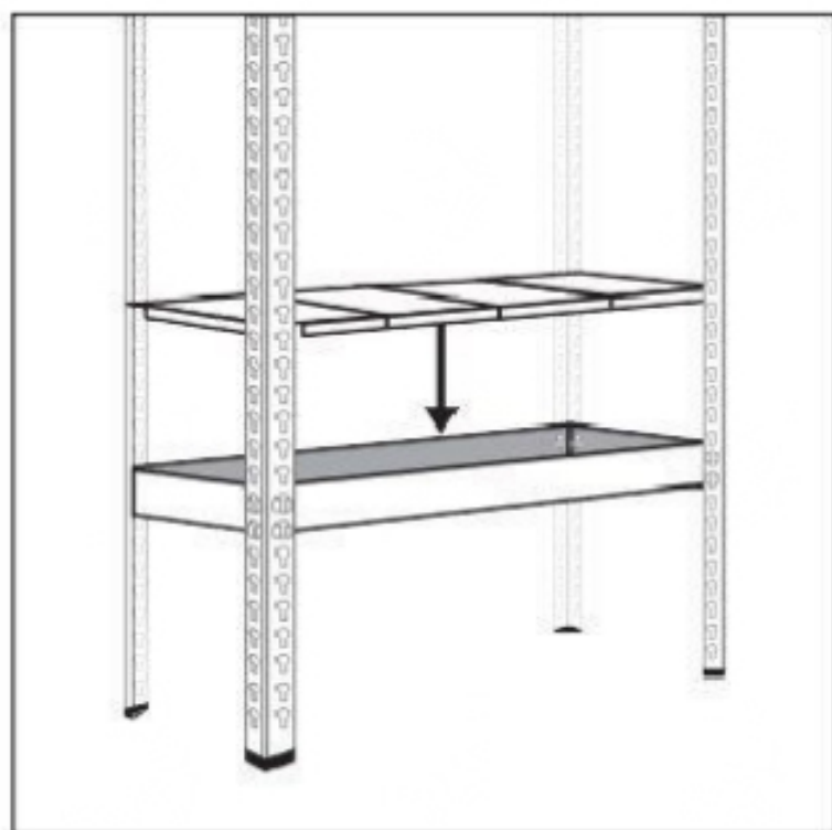
Рис. 5а. Укладка металлического настила
